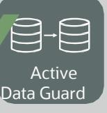
Active Data Guard | 複数のスタンバイ・データベースをサポート：リージョンあたり1つのローカルと最大1つの追加リモート<br>手動および自動フェイルオーバーにより、データ損失を最小限に抑えることが可能                                                                                                                                        |
